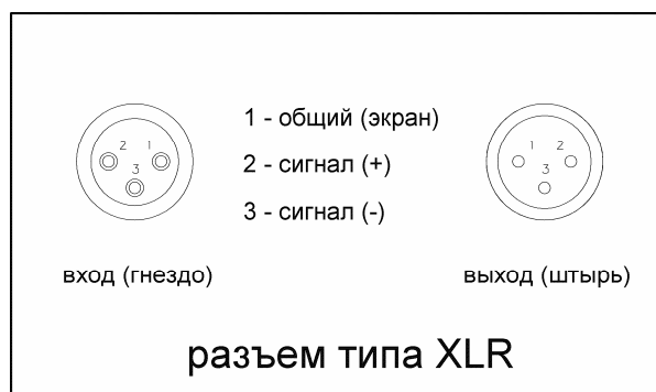
Рис.3. Функциональное назначение выводов разъемов XLR.
